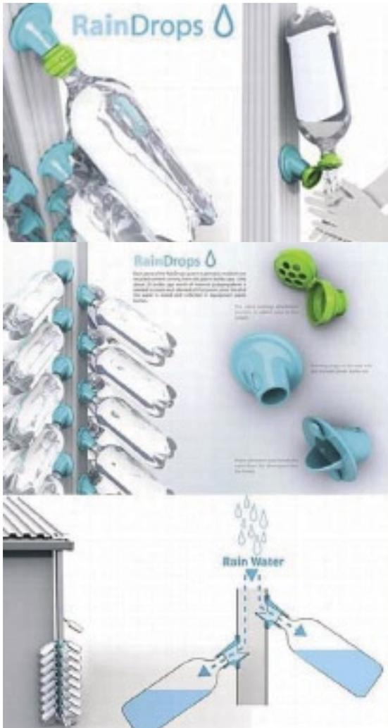
*A sinistra, progetto di recupero dell'acqua piovana attraverso bottiglie di plastica usate da montare lungo i pluviali (Evan Gant).*
