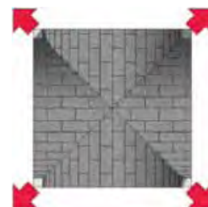
2 Appoggio puntiforme in una volta a crociera. Pianta.
