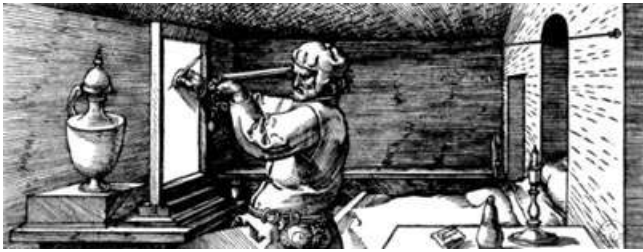
Il vetro in una variante con mirino vincolato da un filo, in una incisione di Dürer (1481).
