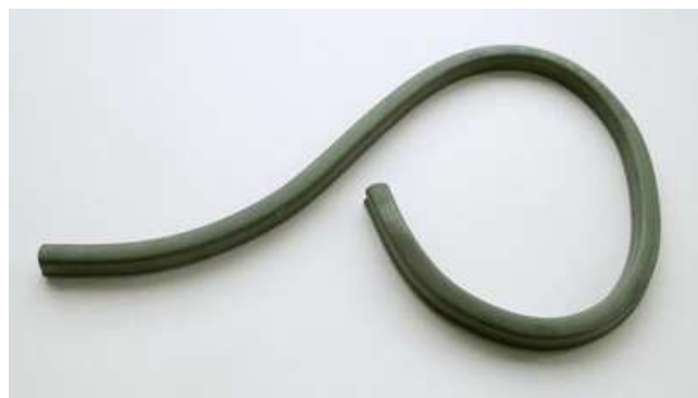
Curvilineo di gomma con anima di piombo (contemporaneo).
