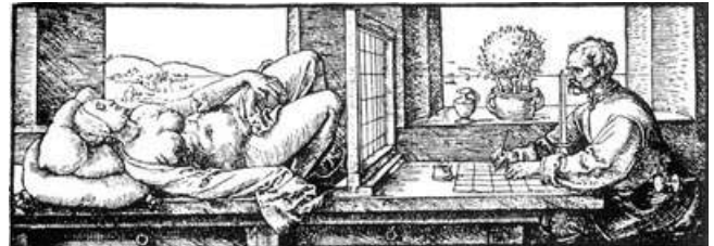
Il velo di Alberti secondo la versione di Albrecht Dürer (1538), che aggiunge il miraglio a forma di obelisco per fissare la posizione dell'occhio.
