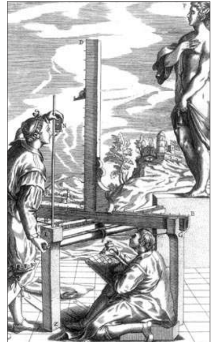
Strumento prospettico da Le due regole della prospettiva pratica del Vignola (1583).
